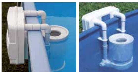
Скиммер предназначен для забора воды из бассейна и ее подачи в фильтровальную установку. Область применения - бассейны малых объемов, облицованные плиткой или пленкой. Площадь обрабатываемой поверхности - 25 м<sup>2</sup>. Возможна установка на борт или за борт бассейна.
