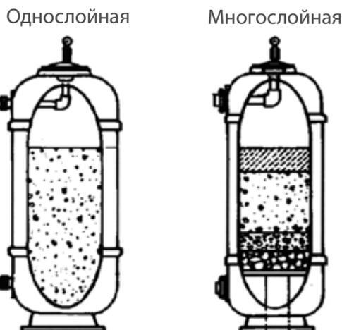
Схема засыпки фильтровального материала
