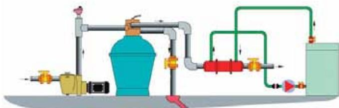
Теплообменник представляет собой цилиндр с внутренним змеевиком, по которому циркулирует теплоноситель. Принцип работы теплообменника основан на разнице температур теплоносителя и воды бассейна. Теплоноситель поступает в теплообменник от котла горячего водоснабжения. В зависимости от его мощности можно использовать либо уже имеющийся котел, либо поставить дополнительный — только
